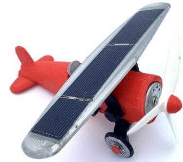
Zu Beginn der Veranstaltung setzen wir den kleinen Mini-Sunny aus einem Bausatz zusammen. Das Modell hat eine große Solarfläche und der Propeller dreht sich schon bei sehr geringem Licht, beispielsweise auf der Fensterbank.
